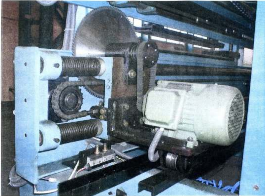
Bild 15: Sägeblatt Antrieb und Führung
